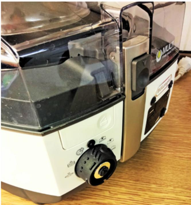
Mit Automatik- und Halbautomatik-Programmen sowie dank des integrierten Rührstabs brennt bei dieser Heißluft-Friteuse nichts an. Die tastbaren Markierungen an den Drehreglern wurden passgenau im 3D-Drucker hergestellt.
