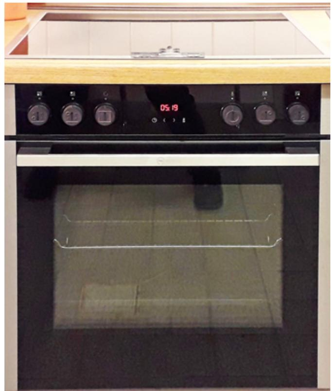
Als ‚modern‘ gilt bei Herden aktuell, alles über Displays zu steuern; für blinde Nutzerinnen und Nutzer sind diese Geräte jedoch nicht bedienbar. Traditionelle Drehschalter lassen sich taktil mithilfe von Markierungspunkten anpassen. Die Firma „Feelware“ hat sich auf die akustische Nachrüstung von Herden/Haushaltsgeräten spezialisiert. Der Herd in der ABSV-Lehrküche sagt die aktuelle Einstellung an, sobald der Drehschalter berührt oder bewegt wird. Pro Schalter ist eine Batterie erforderlich.
